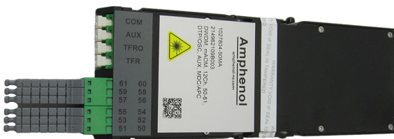
DWDM Module Mini Cassette 1027804-50MA
